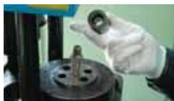
③水圧テストを行い、最後にもう一度長さを確認し、最終検品を経て出荷可能となる
