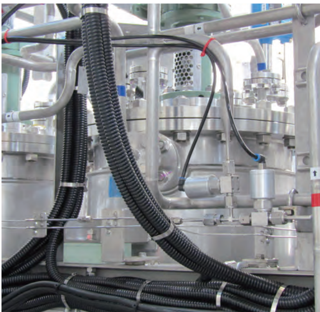
iCube に搭載されているスウェージロックのバルブや継手
